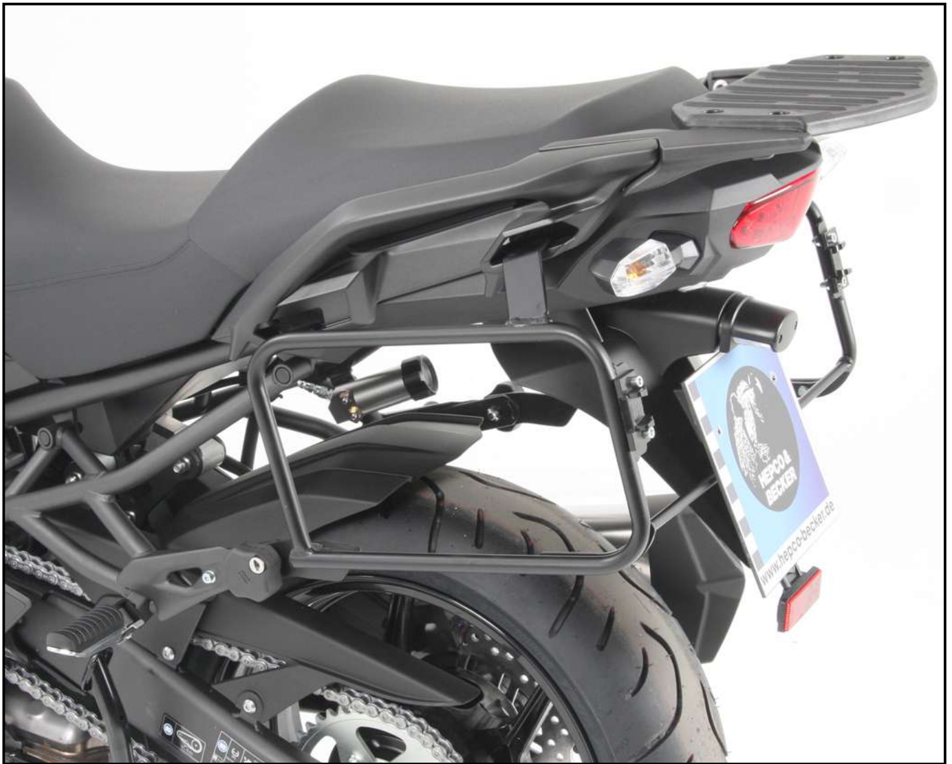
Baubreite des Kofferträgers 52 cm zzgl. Kofferbreite Width of the side carrier 52 cm plus case width
