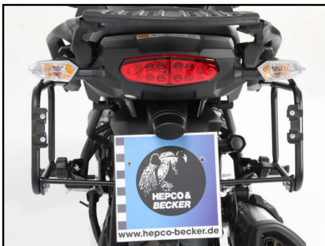
Baubreite des Kofferträgers 52 cm zzgl. Kofferbreite Width of the side carrier 52 cm plus case width
