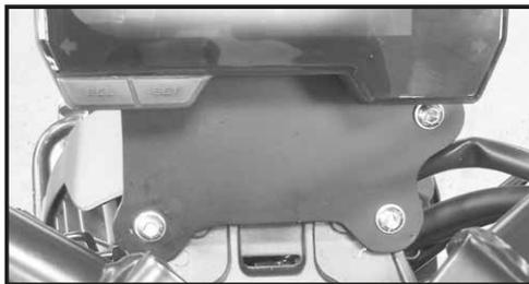
Die Armatur mit den Originalschrauben an der Armaturenverlegung montieren. Nun die Armatur inkl. Verlegung wieder am Motorrad befestigen.
