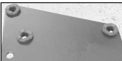
Die beiden Schrauben rechts und links der Scheinwerferbefestigung entfernen und den Scheinwerfer entnehmen und ablegen. Den Stecker der Armatur lösen. Nun die 3 Schrauben der Armaturenbefestigung lösen und die Gummitüllen entfernen.
