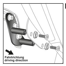
Montage der C-Bow Adapter an die Halteadapter links und rechts:
