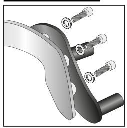
Montage der C-Bows an die C-Bow Adapter links und rechts:
