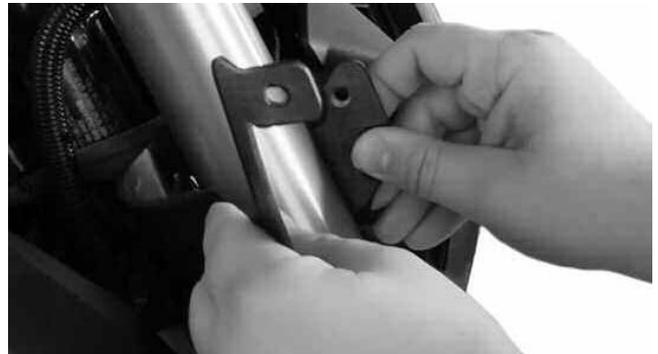
3. Schieben Sie beide Teile zum oberen Ende der Gabel und stellen Sie sicher, dass der Haltearm innerhalb des Bremshebels sitzt und nach vorne zeigt. Schrauben sie beide Teile mittels der M8x20 Schrauben zusammen, ziehen Sie die Schrauben aber noch nicht fest. / *Slide the joined section up to the top of the fork tube, making sure, that the mounting arm is inside the brake lever and pointing forward. Bolt the two sections together with the two M8x20 screws, but don't tighten them up yet.*
