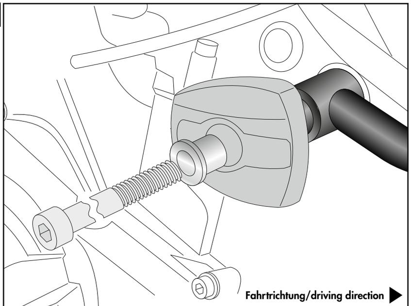
**Montage Motorschutzbügel hinten rechts:**
