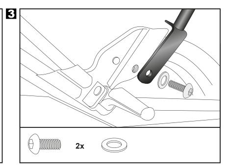
Befestigung der Abstützstreben links und rechts mitte:
