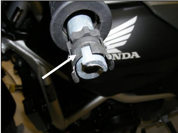
2. Montieren Sie nun die Halter in Fahrtrichtung links (2), in dem Sie zuerst den Spiegel demontieren, den Halter auf den Spiegeladapter auflegen und dann den Spiegel wieder aufschrauben und somit die Halter fixieren.
